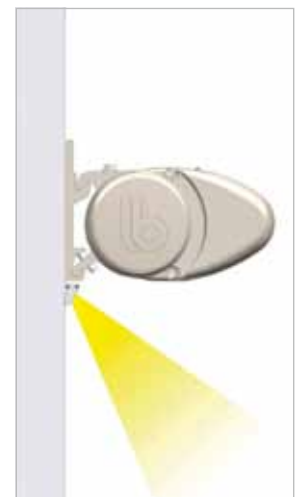
LED strip: bandeau lumineux étanche, monté sur le mur et sous le coffre.
